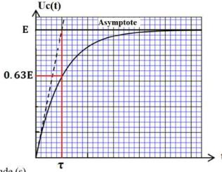
La durée de la charge d'un condensateur de capacité C peut être caractérisée par la constante du temps  $\tau$ =R.C du dipôle RC. Elle peut être déterminée à partir de la courbe représentant les variations de  $U_C(t)$  en fonction du temps par deux méthodes :
